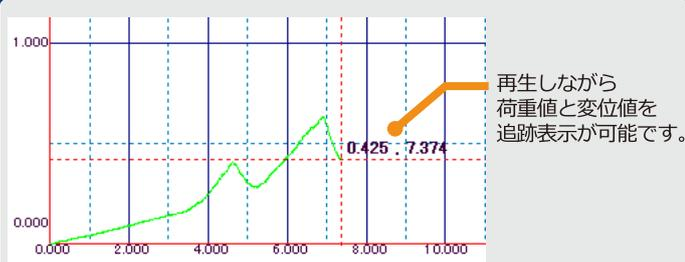
試験結果は後からいつでも呼び出し可能で波形グラフを任意の速度で動画再生する事が出来ます。再生中でも描画速度変更や一時停止が行え、後からいつでもグラフ波形を動的に確認する事が可能です。
