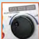
外側にあるシャトルダイヤルを回すことで低速⇒高速の速度変更がダイヤル1つでスムーズに行なえ、内側のジョグダイヤルを回すことで微小な任意の移動量も0.01mm, 0.10mm, 1.00mmの単位で正確に制御できます。
