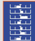
+ 公差、一公差の設定により各ポイントデータ、ばね定数、自由高さ、初張力、密着高さを計測中リアルタイムにバーグラフ表示します。
