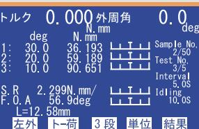
荷重値表示とトルク値表示もワンタッチで切り替え可能ですので図面に合った計測単位を素早く選択していただけます。
